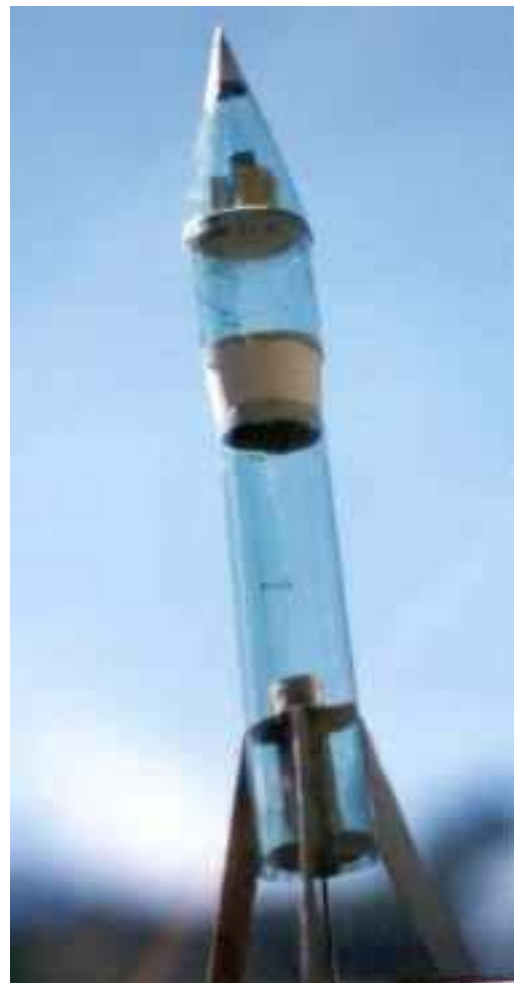
La C-3 avant la peinture. Remarquez le petit satellite dans la coiffe.
